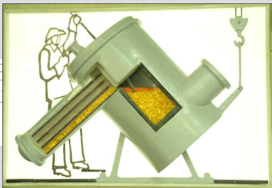
Макет первой рафинировочной печи переплавки черного урана с изложницей
