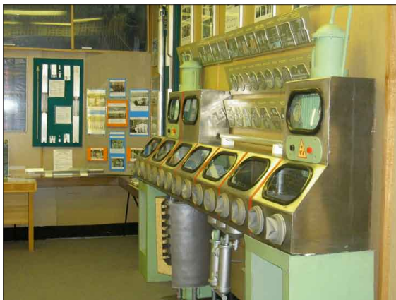
Боксы для работы с опасными для здоровья материалами
